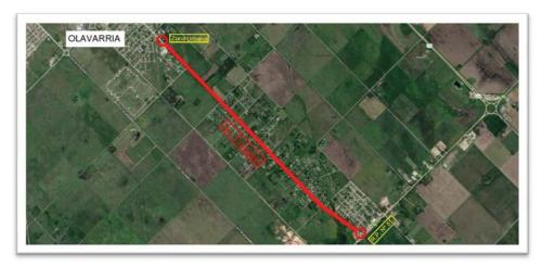
El principio del proyecto coincide con el inicio la intersección con la R.P. Nº51, finalizando esta sección en la progresiva 4+500 coincidente con el inicio de la zona urbana.
